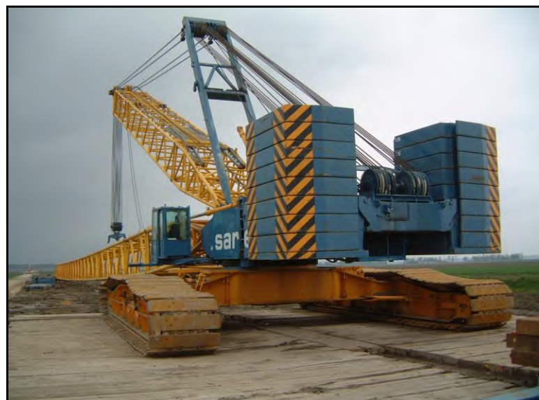
Photographie 9: Grue permettant l'assemblage des différents éléments d'une éolienne
