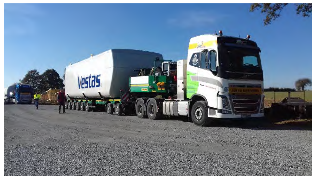
Photographie 10 : Transport de la nacelle
